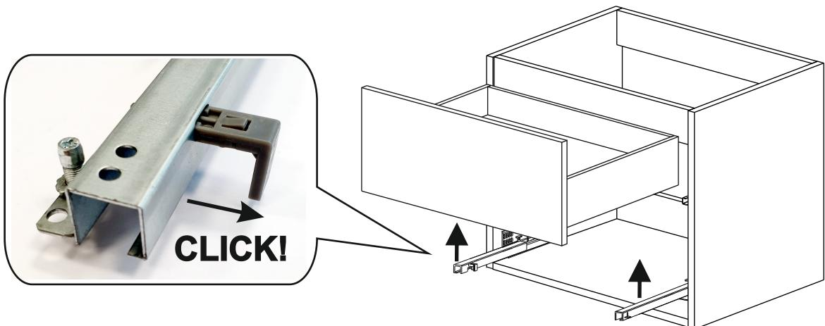
■ Montaggio - Assembling - Einbau - Montage - Τοποθέτηση
